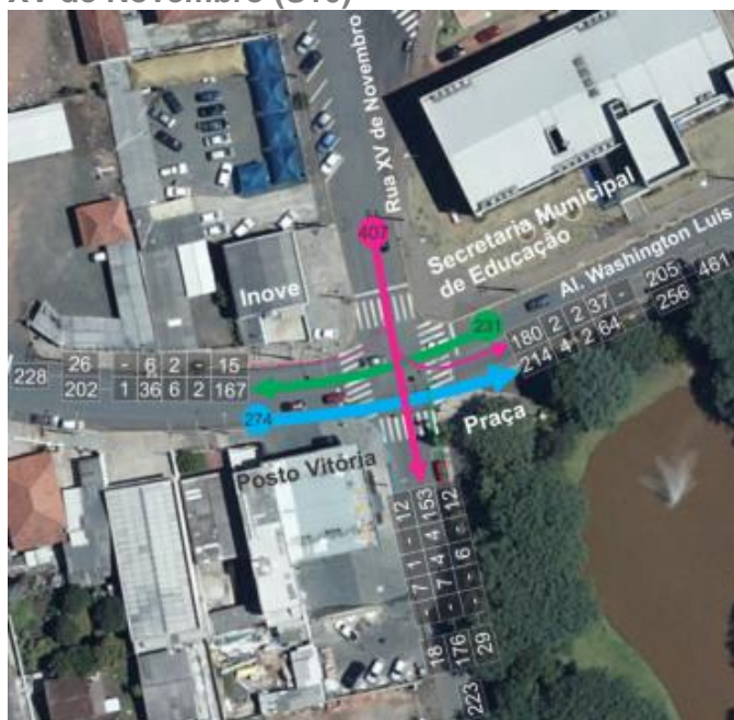
Figura 48 – Interseção e volumes de aproximação da Av. Des. Edmundo Mercer Jr. x R. XV de Novembro (S10)
