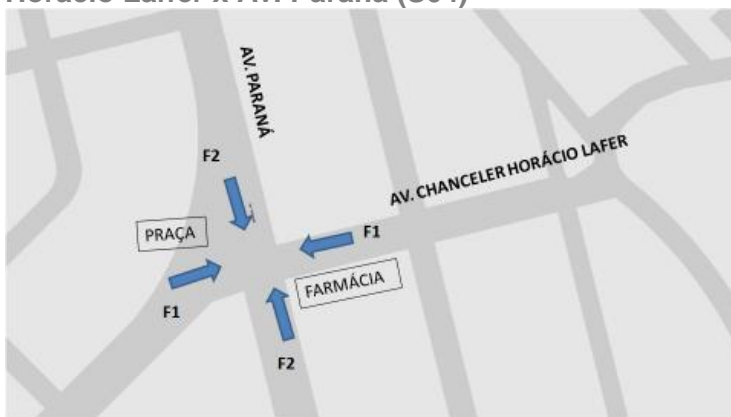
Figura 37 – Diagrama e croqui das fases de semáforo da interseção da Av. Chanceler Horácio Laffer x Av. Paraná (S04)
