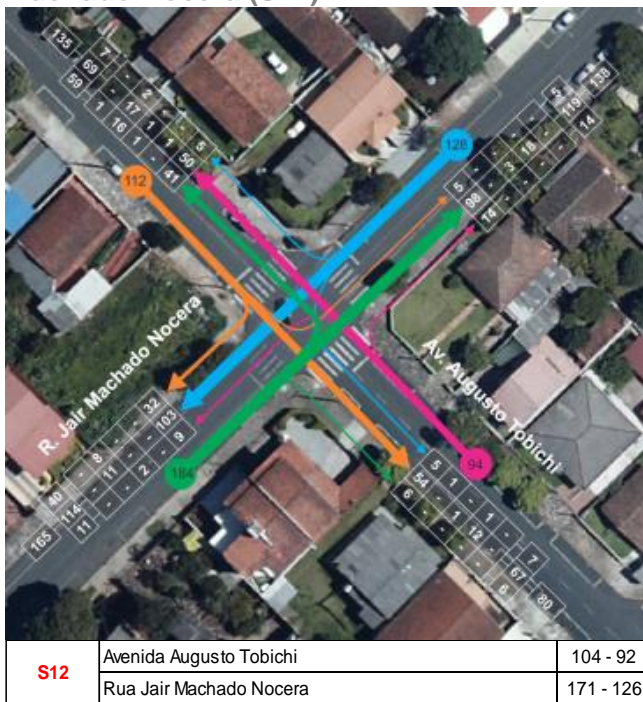
Figura 52 – Interseção e volumes de aproximação da Av. Augusto Tobichi x R. Jair Machado Nocera (S12)
