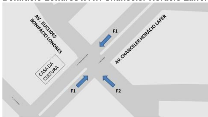
Figura 55 – Diagrama e croqui das fases de semáforo da interseção da Av. Euclides Bonifácio Londres x Av. Chanceler Horácio Laffer (S13)
