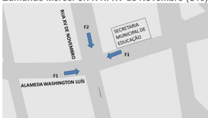
Figura 49 – Diagrama e croqui das fases de semáforo da interseção da Av. Des. Edmundo Mercer Jr. X R. XV de Novembro (S10)
